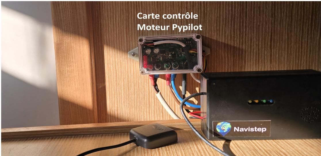
Cette carte Pypilot Open Source de contrôle du moteur du pilote est proche de la table à carte. ( Le boîtier Navistep à côté est un tracker que j'ai conçu et est ici hors projet et installation). Cette carte communique via un port série RX TX avec le Raspberry PI 5 qui donne les ordres, elle est alimentée en 12V et via son microcontrôleur arduino nano et un pont H elle transmet ces ordres et fournit la puissance voulue au moteur du pilote.
